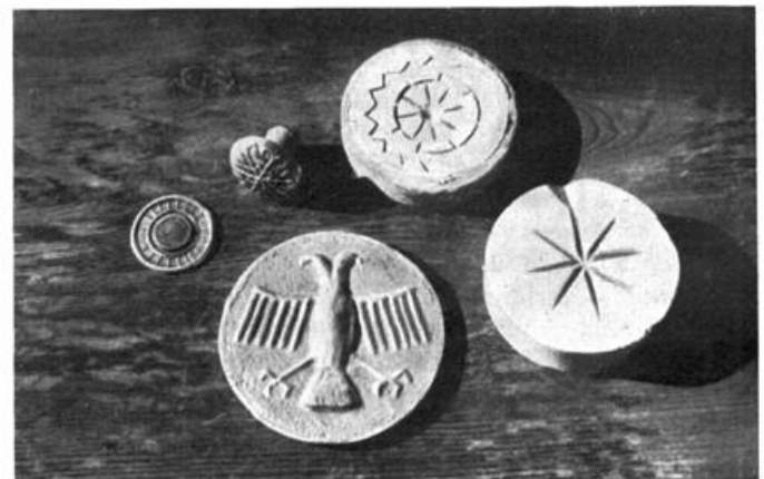
2. Drei Gußstücke aus negativ geschnittenen Formen, in Gipseinbettungsmasse gegossen: Adler aus Aluminium und Knöpfe aus Silber.
